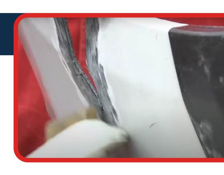
de um raspador ou de um cortador frontal, a fenda em "V" será chanfrada, aumentando também a zona de contato entre o material de base e o material de entrada. O "V" terá um ângulo aproximado entre 60 e 70 graus, e sua profundidade não será maior que 2/3 da espessura do material. É aconselhável começar com cerca de 10 mm na frente do início da fissura e ir aprofundando progressivamente.
